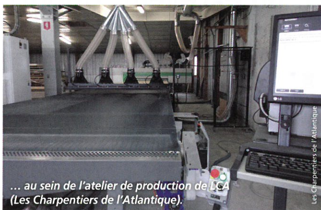
La nouvelle machine de nesting Biesse (Rover B FT 2264) récemment implantée...
